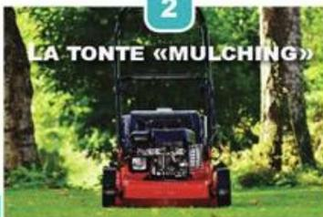
Il s'agit d'une technique de tonte sans ramassage de l'herbe, qui est hachée et directement redéposée sur la pelouse.
